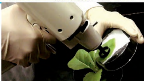
Ryc. 63.3. Transformacja komórek rośliny za pomocą armatki genowej
