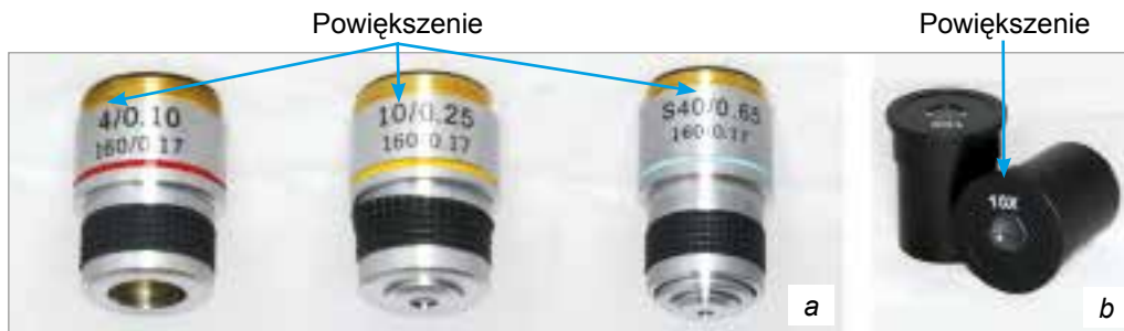
Ryc. 7. Obiektywy (a), okular (b) mikroskopu szkolnego i ich oznaczenia
