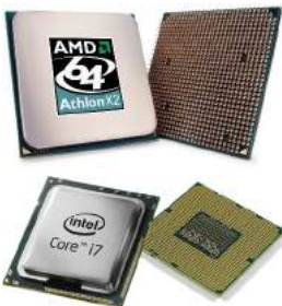
Рис. 2.2. Мікросхеми центрального процесора
