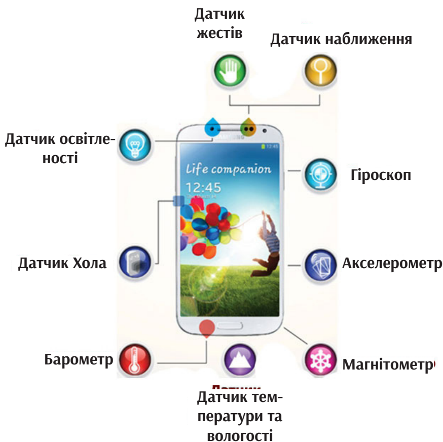
Рис. 2.7. Смартфон – цифровий вимірювальний комплекс
