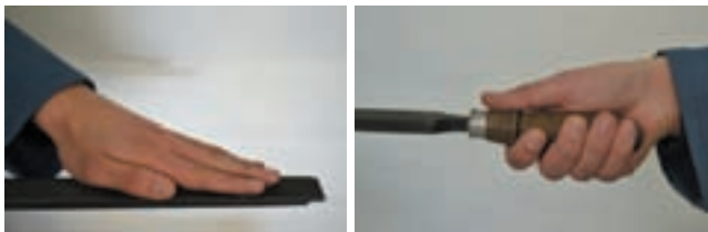
Рис. 8.8. Правила роботи напилком
