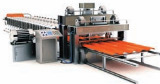
Рис. 2.3. Багатовалковий прокатний стан
