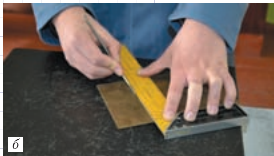
Рис. 5.5. Розмічання за допомогою лінійки і рисувалки
