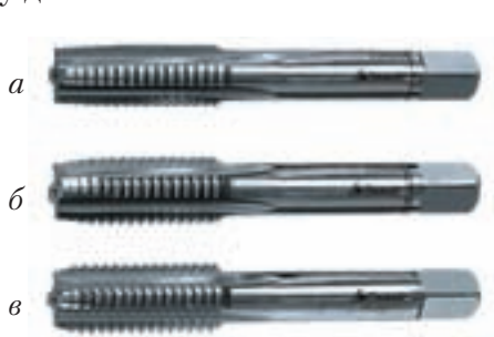
Рис. 10.5. Комплект мітчиків: а – чорновий; б – середній; в – чистовий
