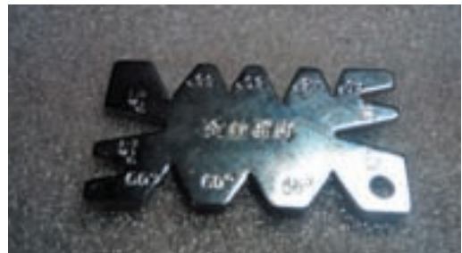
Рис. 7.8. Шаблон для перевірки кута загострення
