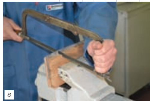
Рис. 6.6. Прийоми роботи ножівкою
