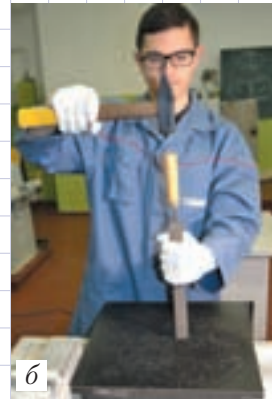
Рис. 8.7. Кріплення ручки напилка на хвостовику: a – правильно; б – неправильно
