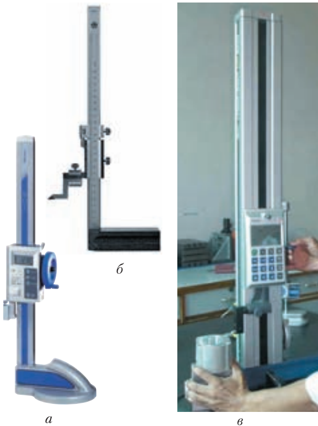
Рис. 5.7. Штангенрейсмас: а – електронний; б – зі шкалою ноніуса; в – вимірювання висоти заготовки за допомогою штангенрейсмаса
