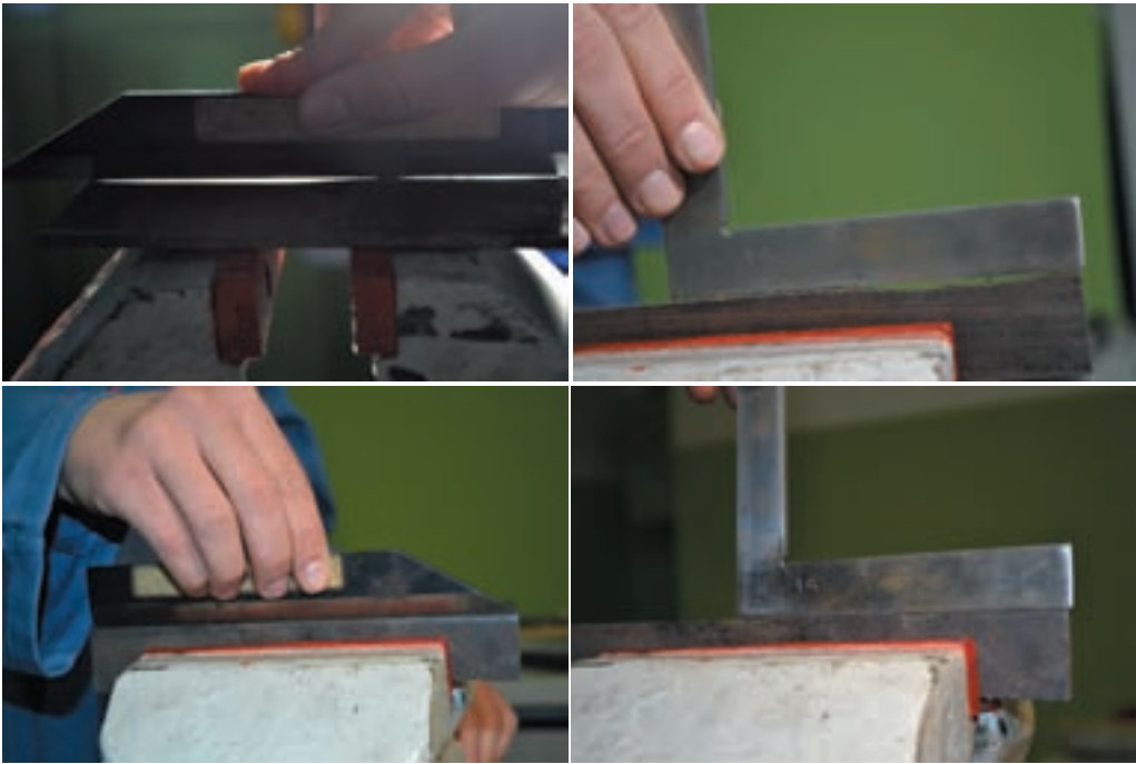
Рис. 8.10. Перевірка якості обпилювання
