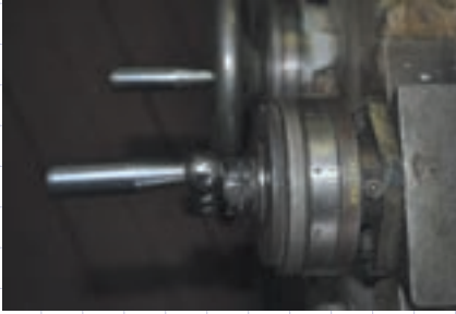
Рис. 11.11. Лімба поперечної подачі
