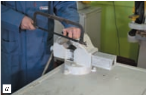
Рис. 6.6. Прийоми роботи ножівкою
