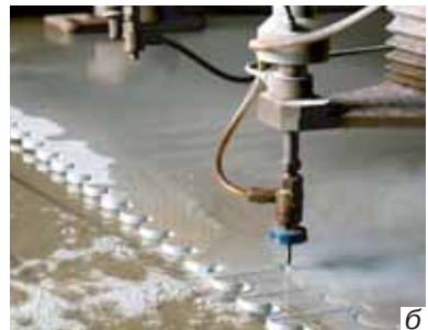
Мал. 89: а — деталі з металу в повсякденному житті й на виробництві; б — різання водою (гідроабразивне різання)
