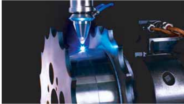
Мал. 171. Лазерне зварювання вала-шестерні
