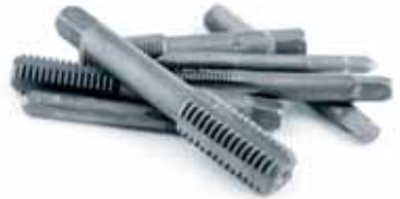
Мал. 154. Мітчики для нарізування внутрішньої різьби
