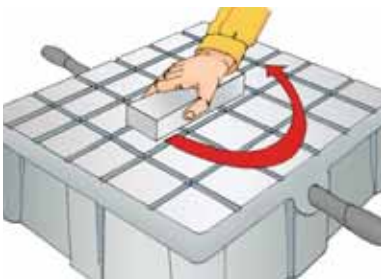
Мал. 134. Правильна плита для точної перевірки площинності обпиляної деталі
