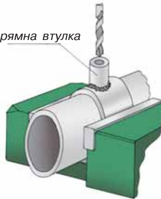
Мал. 144. Варіанти фіксації свердла на осі отвору за допомогою: а — фрезерованої або обпиленої полиці; б — напрямної втулки
