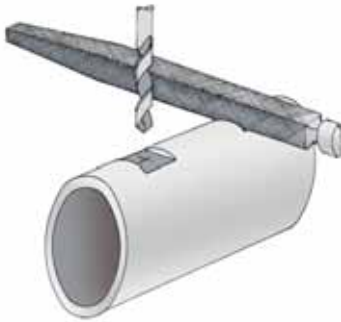
Мал. 144. Варіанти фіксації свердла на осі отвору за допомогою: а — фрезерованої або обпиленої полиці; б — напрямної втулки
