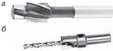
Мал. 141. Циліндричні зенківки з напрямними елементами у вигляді цапфи (а) або спірального свердла (б)
