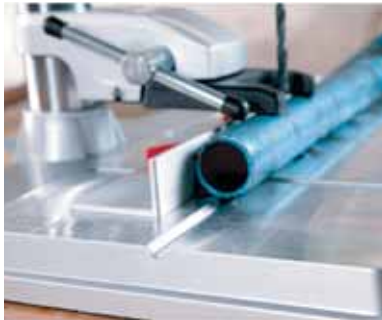
Мал. 143. Використання призматичної підставки для жорсткої фіксації виробу
