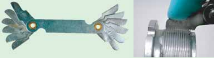
Мал. 164. Різьбовий щуп (а) і спосіб його використання (б)
