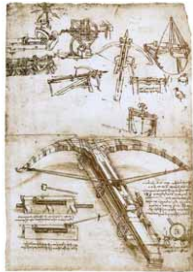
Мал. 34. Технічний рисунок гігантського арбалета Леонардо да Вінчі
