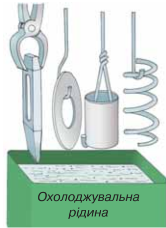
Мал. 32. Приклади правильного занурення деталей в охолоджувальну рідину для загартування
