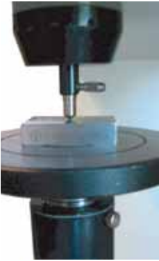
Мал. 28. Вимірювання твердості металу за методом Роквелла
