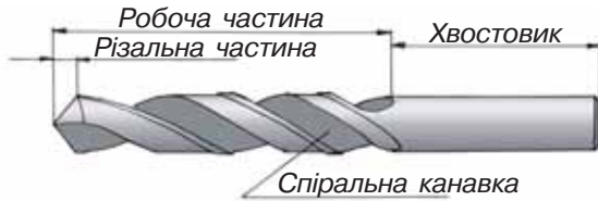
Мал. 136. Основні частини спірального свердла
