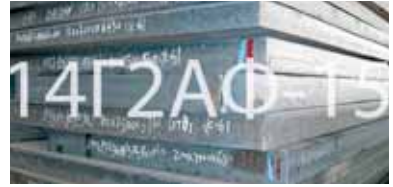
Мал. 1. Приклад маркування сталевого прокату
