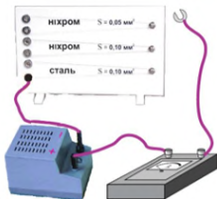
Рис. 28.1. Дослід для визначення залежності опору металевого провідника від його довжини, площі поперечного перерізу та роду речовини
