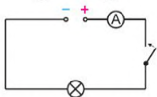
Рис. 25.3. Вимірювання сили струму амперметром: а) амперметр вмикається в електричне коло послідовно; б) покази амперметра в різних точках електричного кола однакові
