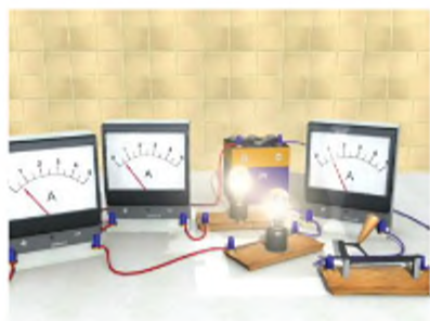
Рис. 30.4. При паралельному з'єднанні провідників струм у точках з'єднання розгалужується
