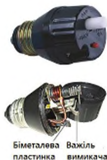
Рис. 4.3. Принцип дії автоматичного побутового запобіжника ґрунтується на тепловому розширенні біметалевої пластинки
