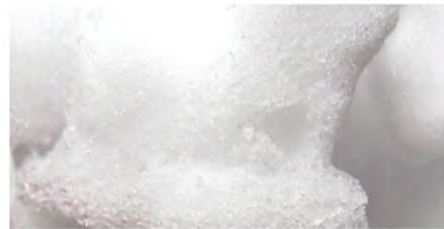
Рис. 2. При підвищенні температури сніг ущільнюється і його теплопровідність зростає
