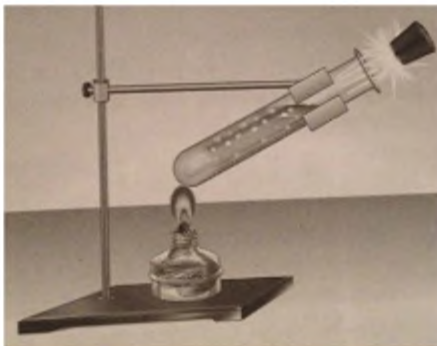
Рис. 15.1. Перетворення внутрішньої енергії води в кінетичну енергію руху корка
