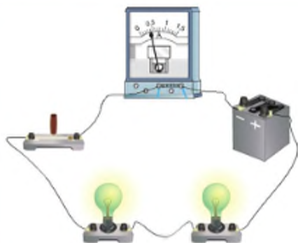
Рис. 29.3. Послідовно увімкнений амперметр вимірює силу струму в електричному колі
