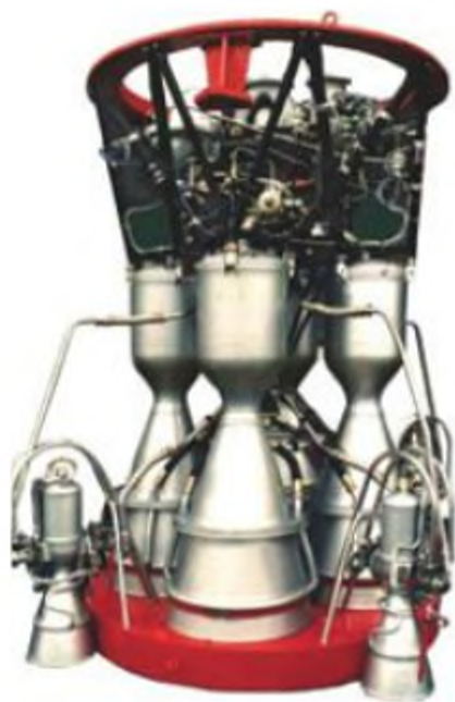
Рис. 1. Реактивний двигун РД-108 конструкції В. П. Глушка для ракети-носія Р-7 С. П. Корольова
