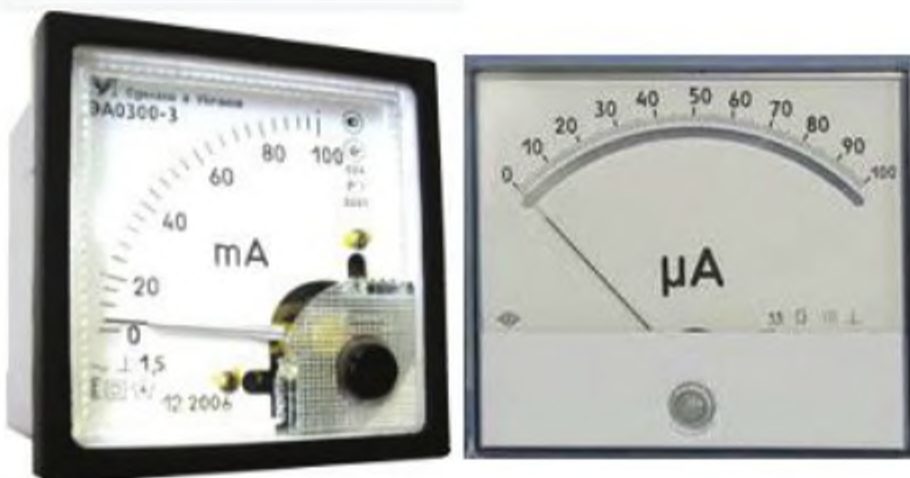
Рис. 25.5. Мілі- та мікроамперметри використовують для вимірювання малих струмів
