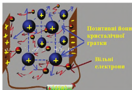
Рис. 27.2. Рух вільних електронів у провіднику сповільнюється внаслідок їх взаємодії з йонами кристалічних ґраток
