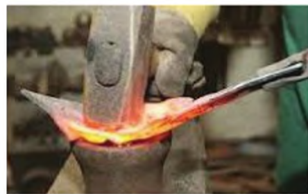
Рис. 2.2. Щоб змінити форму залізної деталі, її попередньо сильно нагрівають та прикладають значні зусилля.
