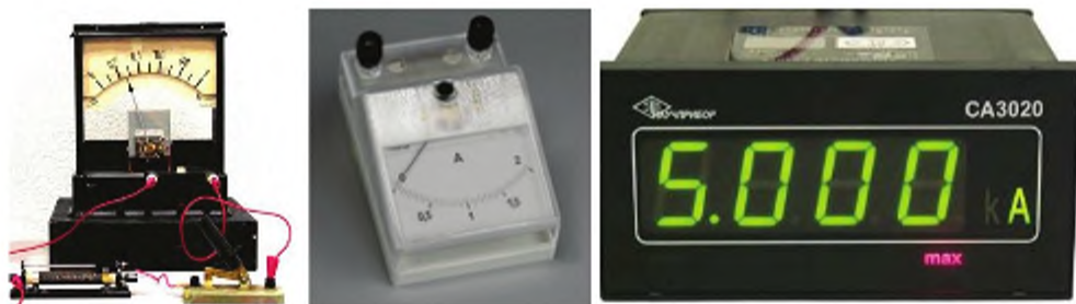
Рис. 25.2. Амперметри: а) демонстраційний; б) лабораторний; в) цифровий
