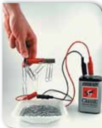
Мал. 135. Магнітна дія струму
