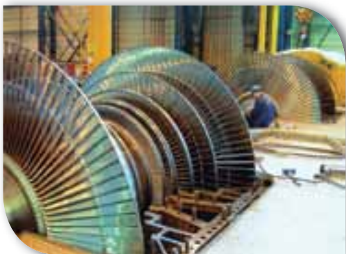
Мал. 69. Потужна промислова багатоступінчата турбіна виробництва «Турбоатом»
