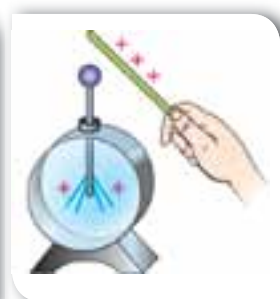
Мал. 113. Електро́скоп: а — зовнішній вигляд; б, в — механізм електризації; г — принцип дії
