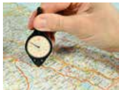
Кривые линии на карте измеряют с помощью курвиметра
