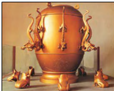
Китайський прилад для визначення коливань земної кори. Під час землетрусу із пац металевих драконів у розкриті пащечки пустотілих жабок, розташованих напроти, двійко падали кульки
