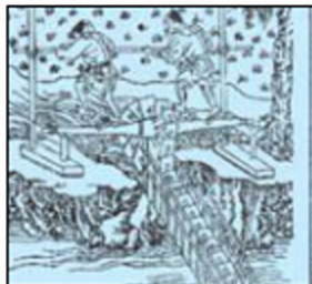
Водяний насос з ножним приводом. Подавав воду на поля. З малюнка XIV ст.
