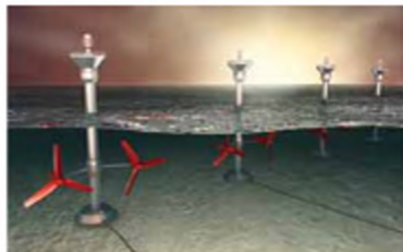
Мал. 286. Турбіни на дні моря, що використовують енергію припливів
