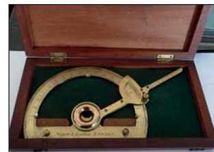
Старовинні латунні транспортри. Горі. Транспортир, виготовлений у Німеччині близько 1700 р. (на лінійковій основі — орнамент у стилі бароко). Вважає його схожість із сучасним «шкільним» транспортиром. Внизу. Транспортир знаменитої англійської фірми точних інструментів Negretti & Zambra з поворотним кронштейном (XIX ст.)
