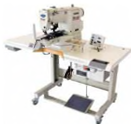
Мал. 78. Швейна машина човникового стібка для пришивання гудзиків впотай
