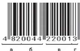
Мал. 99. Штриховий код: а — код країни; б — код виробника; в — код товару; г — контрольна цифра
