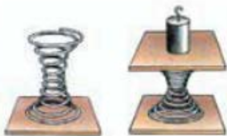
Рис. 111. Дослід з деформацією пружини: а) пружина у недеформованому стані; б) деформація пружини під дією гирі
