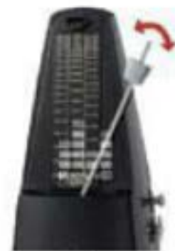
Рис. 73. Приклади фізичних маятників: а) лінійка, що коливається навколо закріпленої осі; б) ніжка із тягарцем у метрономі
