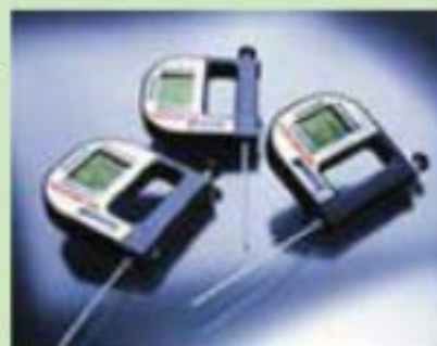
Рис. 100. Сучасні цифрові ареометри (густиноміри)
