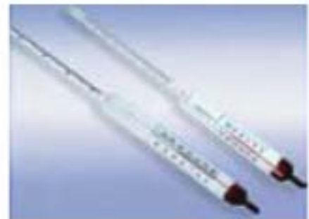
Рис. 99. Ареометр — прилад для вимірювання густин рідин
