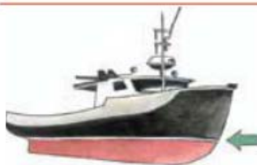
Рис. 196. Найбільш допустима осадка судна — ватерлінія
