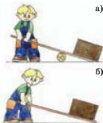
Рис. 208. Використання важелів для піднімання вантажу: а) важіль першого роду (лом); б) важіль другого роду (тачка)
