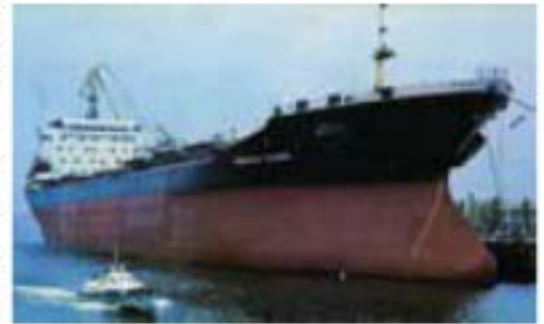
Рис. 197. Сухогруз «Микола Бажан» Чорноморського пароплавства (порт приписки Одеса), побудований на Миколаївському суднобудівельному заводі «Океан». Довжина судна — 215,4 м, осадка 12,3 м, водотоннажність 50150 т
