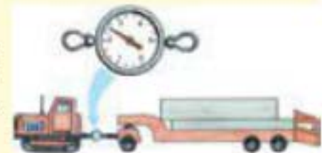
Рис. 121. Вимірювання сили тяги трактора
