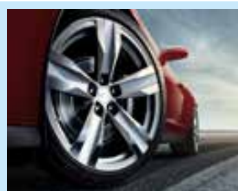
Мал. 31.2. Колесо автомобіля має дві кінетичні енергії – обертову і поступальну
