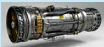
Мал. 37.8. Турбореактивний двигун сучасного літака має біля 6000 високотехнологічних деталей
