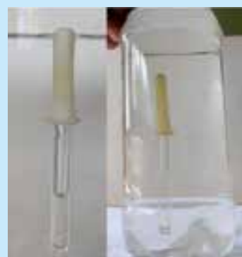
Мал. 29.3. «Картезіанський водолаз», зроблений з піпетки і пластикової пляшки
