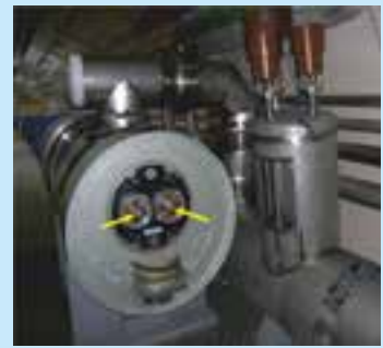
Мал. 37.9. Система охолодження і дві трубки, якими рухаються протони
