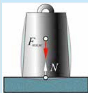
Мал. 20.4. Сила тяжіння і сила реакції опори компенсують одна одну
