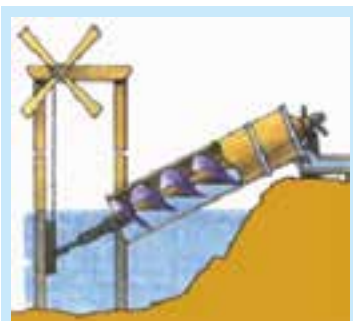
Мал. 27.6. Гвинт Архімеда дозволяє перекачувати пульпу (суміш глини і води)
