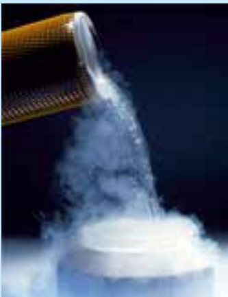
Мал. 3.4. Рідкий азот кипить при -196\text{ }^{\circ}\text{C}
