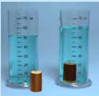
Мал. 6.8. Поділки мензурки визначають об'єм у мілілітрах (тобто \text{см}^3 )
