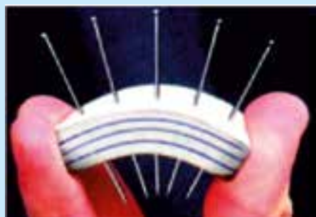
Мал. 20.9. Деформація згину показує, що внутрішня частина гумки не деформується
