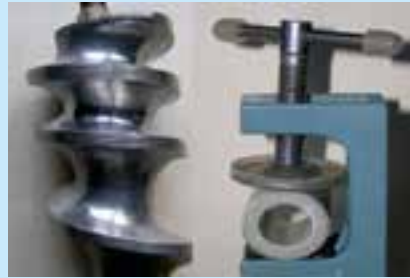
Мал. 34.9. Шнecк м'ясорубки і гвинт струбцини – різновиди похилої площини
