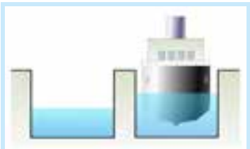
Мал. 28.4. Парадокс Архімеда: корабель може плавати в малій кількості води
