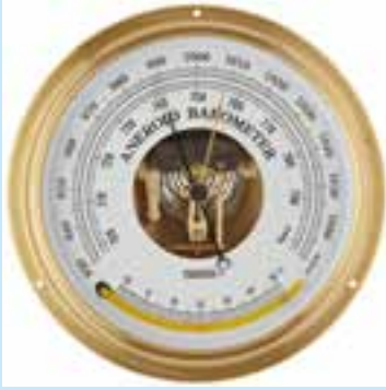
Мал. 26.8. Барометр-анероїд. Принцип дії
