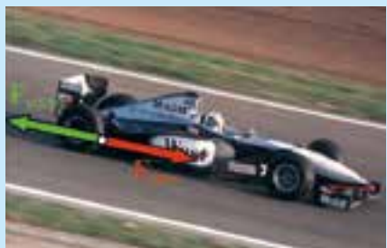
Мал. 21.10. Сила тяги прискорює автомобіль, а сили тертя й опору повітря зменшують його швидкість
