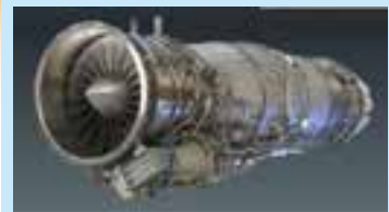
Мал. 15.4. Вал турбіни реактивного двигуна робить 30 000 обертів за хвилину
