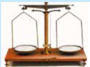
Мал. 19.2. Масу тіла визначають за допомогою важільних терезів
