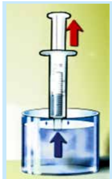
Мал. 27.4. Вода рухається за поршнем насоса, бо її туди «втискає» сила атмосферного тиску
