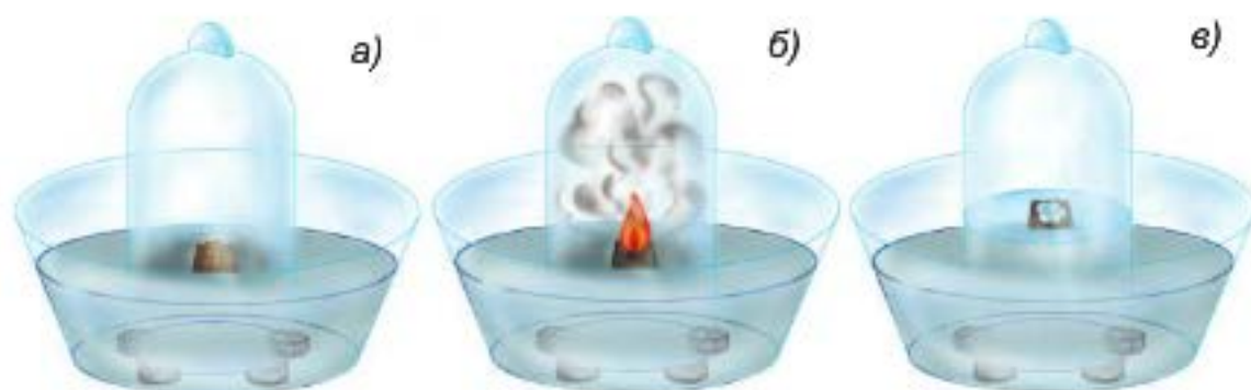
Мал. 74. Визначення складу повітря: а — перед дослідом; б — фосфор горить; в — дослід закінчено.
