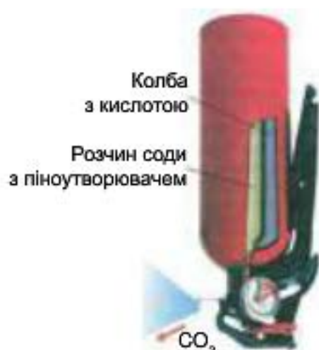
Мал. 72. Кислотний вогнегасник у дії
