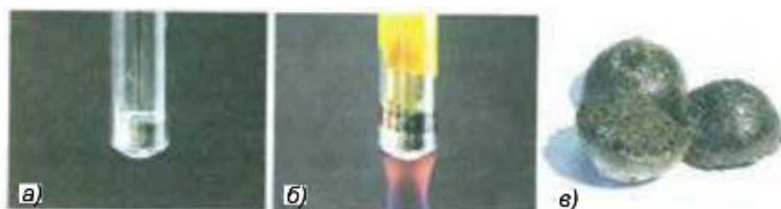
Мал. 73. Взаємодія заліза із сіркою: а — вихідна суміш; б — реакція відбувається під час нагрівання; в — продукт реакції — ферум(II) сульфід FeS
