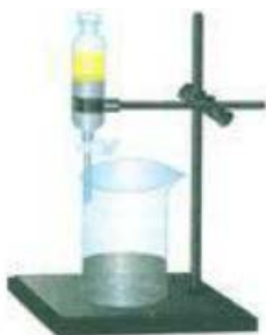
Мал. 52. Розділення суміші двох рідин, які не розчиняються одна в одній, у ділильній лійці
