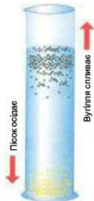
Мал. 51. Розділення суміші річкового піску і вугілля відстоюванням
