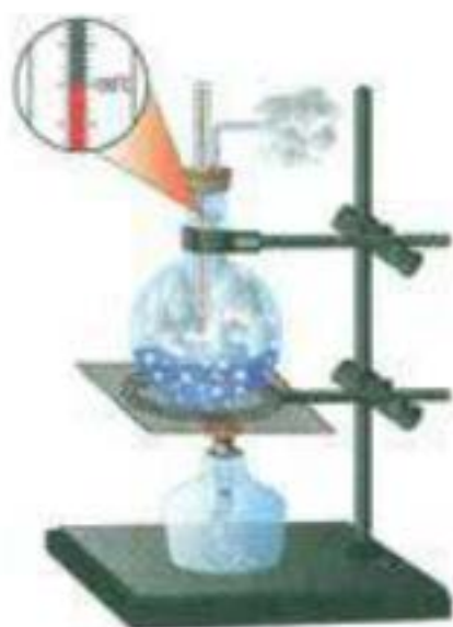
Мал. 49. Визначення температури кипіння рідини
