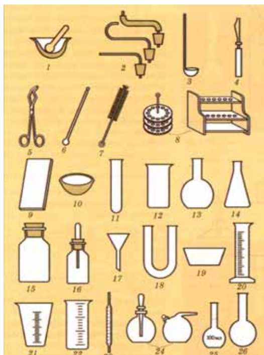
Мал. 13. Хімічний посуд та інше лабораторне обладнання: ступка з товчачиком; 2- газівідвідні трубки з пробками; 3- ложка для спалювання речовин; 4- пробіркотримач; 5- тигельні щипці; 6- скляна паличка; 7- йоржик; 8- штатив для пробірок; 9- скляна пластинка; 10- чашка для випарювання; 11- пробірка; 12 — хімічна склянка; 13- колба плоскодонна; 14- колба конічна; 15- банка; 16- склянка з піпеткою; 17- лійка; 18 — U- подібна трубка; 19 — кристалізатор; 20- мірний циліндр; 21- мензурка; 22- мірна склянка; 23 — піпетка градуйована; 24 — крапельниця; 25- мірна колба; 26 — кругло донна колба.
