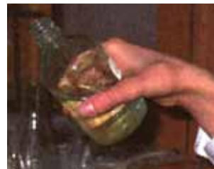
Мал. 9. Так потрібно брати банку з реактивом, щоб етикетка спрямовувалась у бік долоні.
