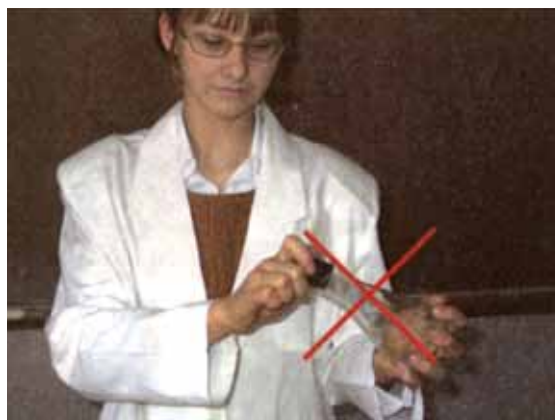
Мал. 26. Закривання колби пробкою: а — правильне; б — неправильне.
