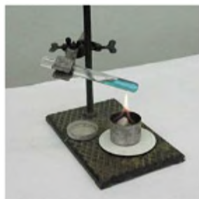
Мал. 13. Нагрівання пробірки з рідиною
