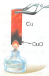
Мал. 46. Прожарювання мідної пластинки
