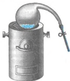
Мал. 51. Прожарювання металу в запаяній реторті
