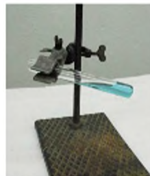
Мал. 9. Закріплення пробірки в тримачі лабораторного штатива
