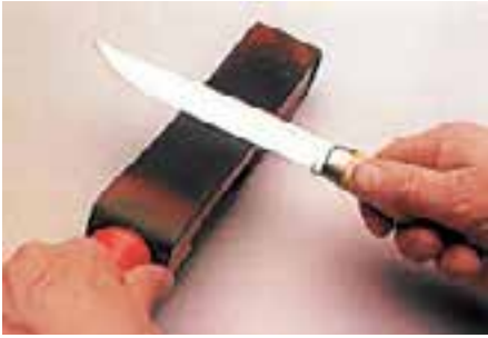
22.4. ábra. Kisebber erő kifejtése érdekében a szerszámokat megélezik
