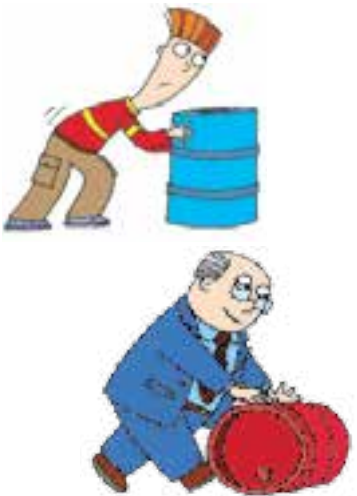
21.9. ábra. A tolás görgetésre való cseréjével csökken a súrlódási erő
