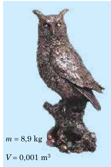
16.5. ábra. Az anyag sűrűsége, amelyből a tömör szobor készült, 8900 \text{ kg/m}^3 . Valószínűleg rézből öntötték
