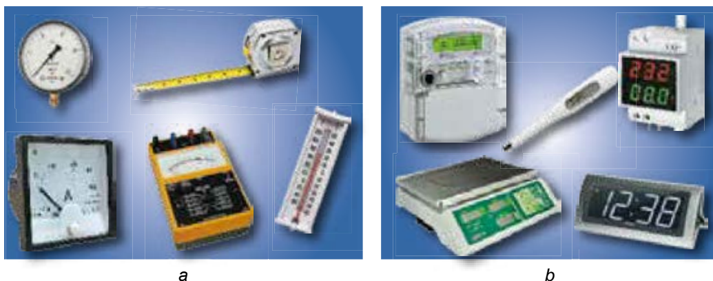
4.6. ábra. Mérőkészülékek: a – skálával ellátott; b – digitális
