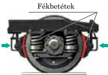
33.4. ábra. A vonat kereke fékezés közben
