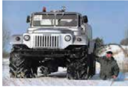
22.5. ábra. Az ember besüppedt a hóba, a terepjáró viszont a hó felszínén maradt
