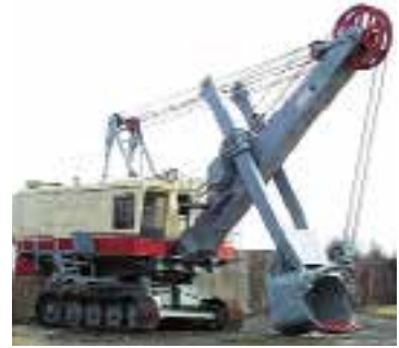
35.2. ábra. A bányákban használatos markológépeken lévő állócsiga segítségével az erők hatása bármely szögben megváltoztatható
