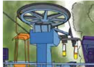
35.3. ábra. A felvonó mechanizmusában található állócsiga ellenkezőjére változtatja a kötélpálya húzóerejét (tehát a kötel mozgási irányát is)
