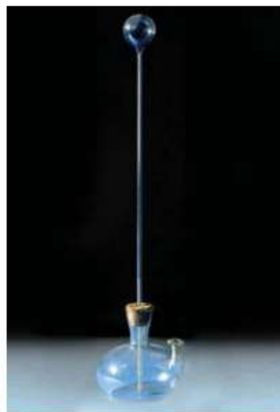
Мал. 115. Галілео Галілей (а) і винайдений ним термоскоп (б)
