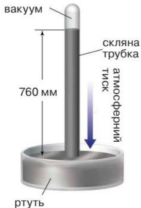
Мал. 124. Схематичне зображення ртутного барометра
