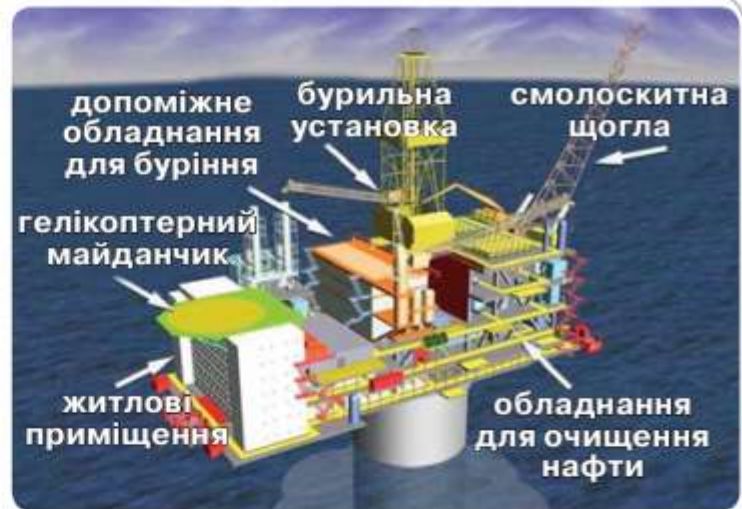
Мал. 92. Складові частини нафтової бурової платформи в океані.
