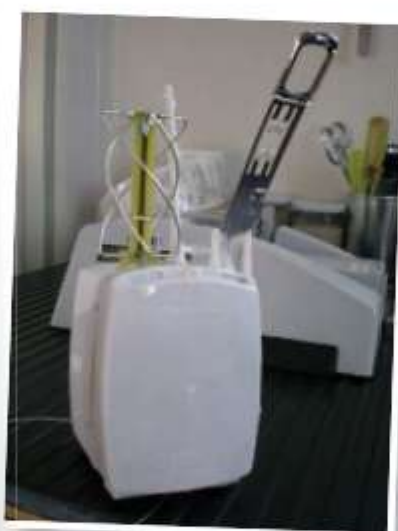
Мал. 154. Радіозонд — комплект приладів масою 250–500 г (а), підвішений до великої повітряної кулі (б)
