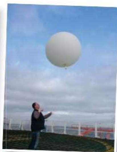
Мал. 154. Радіозонд — комплект приладів масою 250–500 г (а), підвішений до великої повітряної кулі (б)
