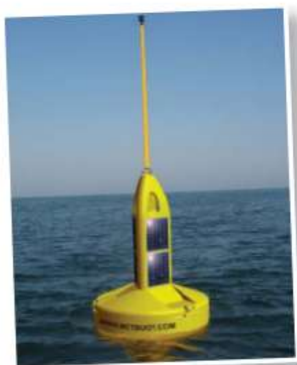
Мал. 153. Метеорологічний буй — автономна плаваюча установка
