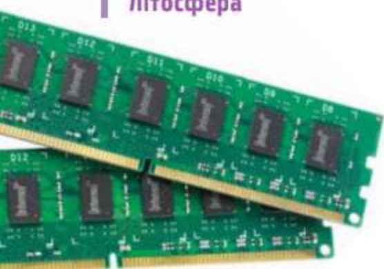
Мал. 86. Позолочені контакти електронних мікросхем
