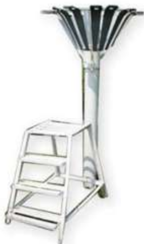
Мал. 148. Спеціальна конструкція для запобігання видування опадів
