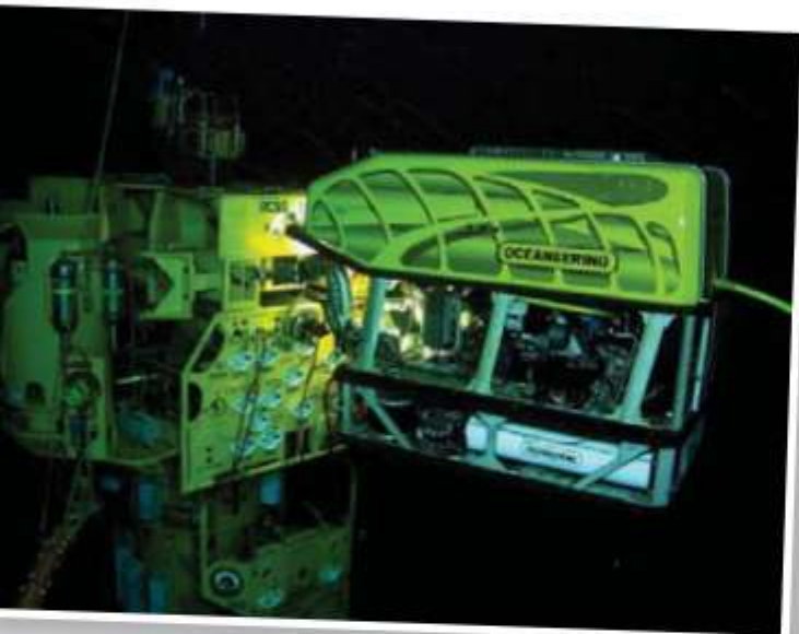
Мал. 172. Дистанційно керований підводний апарат для дослідження родовищ нафти
