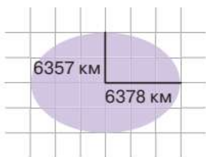
Мал. 12. Схематичне зображення еліпса з двома значеннями радіусів Землі (полярного і екваторіального)
