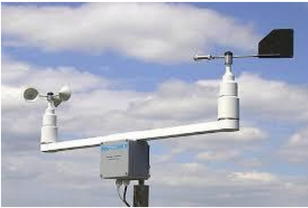
Анемометр чашковий із системою захисту від обледеніння
