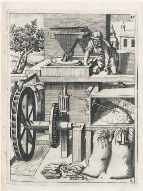
Схема водяного млина з питлем. Гравюра з книжки Г. А. Беклера Theatrum Machinarum Novum (1661)
