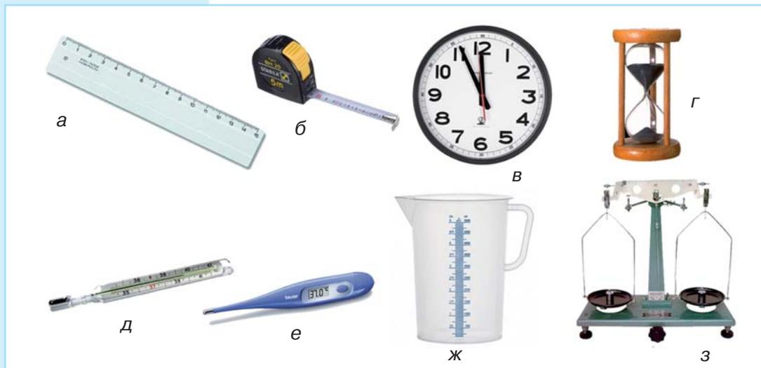
**Рис. 3.** Измерительные приборы: а — линейка; б — рулетка; в — настенные часы; г — песочные часы; д — ртутный термометр; е — электронный термометр; ж — мерный стакан; з — весы
