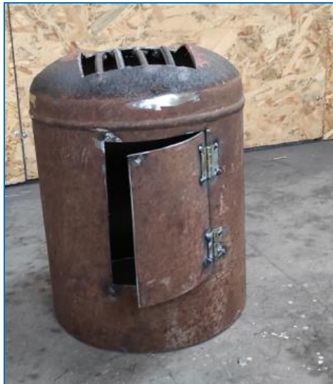
Рис.7. Виготовлення дверцят грубки-«буржуйки»
