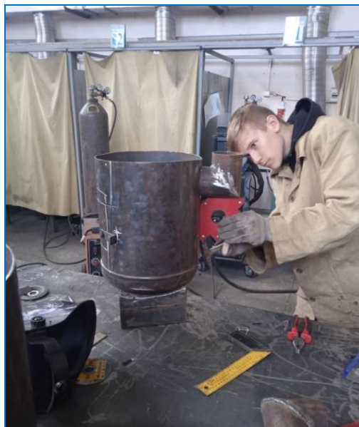
Рис.8. Перевірка розташування відводу відносно корпусу магнітним кутником
