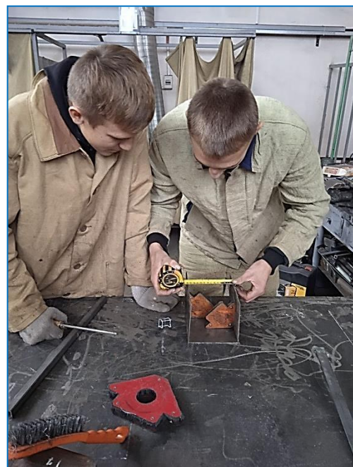
Рис.5. Розмічання деталей конструкції
