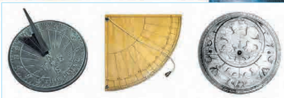
Imag. 57. Instrumente simple pentru cercetarea Universului: a – gnomon; b – cvadrant; c – astrolab
