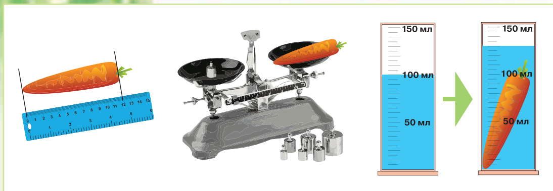
Imag. 10. Măsurarea dimensiunilor, masei și volumului corpurilor cu formă neregulată
