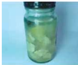
Мал. 49. Зберігання натрію під шаром гасу
