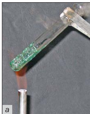
Мал. 20. Нагрівання рідини у пробірці: а — закріпленій у пробірко- тримачі; б — закріпленій у штативі
