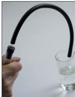
Мал. 69. Перевірка приладу на герметичність
