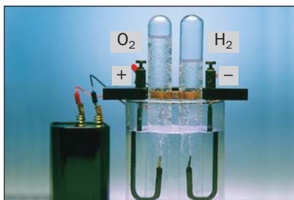
Мал. 65. Розклад води постійним електричним струмом
