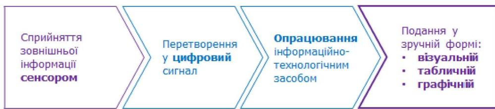
Рис. 12. Етапи опрацювання даних вимірювання засобами цифрового вимірювального комплексу
