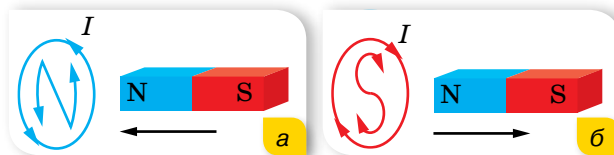
Мал. 92. Визначення напрямку індукційного струму
