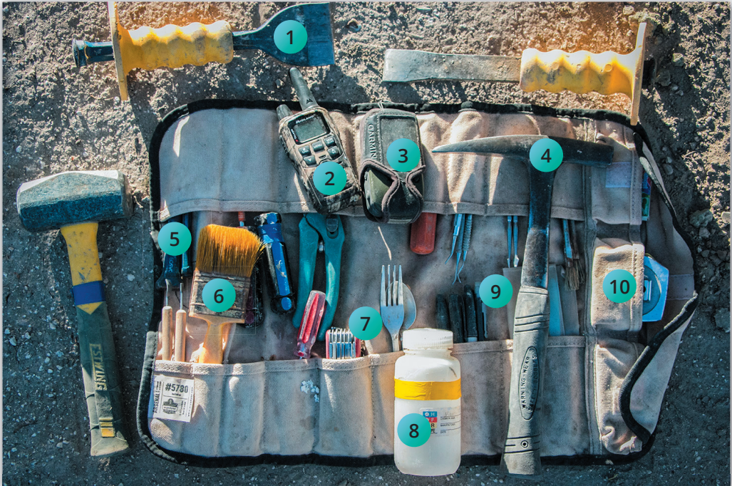
Набір інструментів професійного палеонтолога 1 – велике долото, 2 – рація, 3 – GPS-навігатор, 4 – скельний молоток, 5 – дрібні долота, 6 – пензлик, 7 – швейцарський ніж, ложка і виделка, 8 – клей, 9 – маркери і мішечки для зразків, 10 – рулетка
