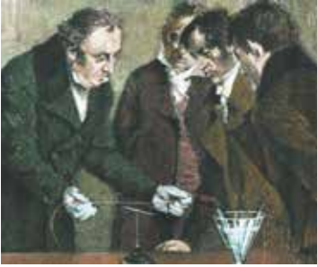
10.1. ábra. Oersted kísérlete: az áramjárta vezető közelében a mágnesű kitér az észak-dél irányból, és a vezetőre merőleges helyzet elfoglalásához törekszik
