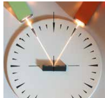
25.4. ábra. A fénysugarak megfordíthatóságának bemutatása: a tükörről visszavert sugár a beeső sugár vonalán halad
