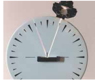
25.3. ábra. A beesési szög megváltoztatásával megváltozik a visszaverődési szög is. A visszaverődési szög minden esetben egyenlő a beesési szöggel
