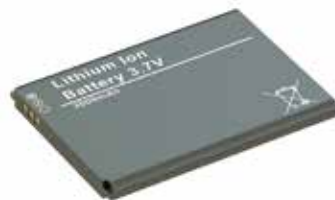
4.5. ábra. Telefon lítium-ion akkumulátora. Az EME a felületén van feltüntetve
