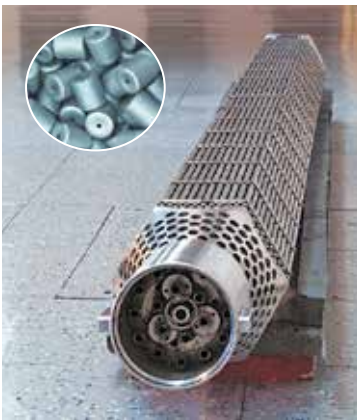
42.4. ábra. Fűtőelemek – fűtőanyagot tartalmazó berendezés ( {}^{235}_{92}\text{U} izotóppal dúsított urán(IV)-oxid tabletták)
