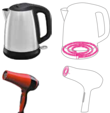
3.3. ábra. Bármilyen melegítő berendezés fő eleme az izzószál, amely nagy fajlagos ellenállású, nem éghető anyagból készül és viszonylag kis keresztmetszetű
