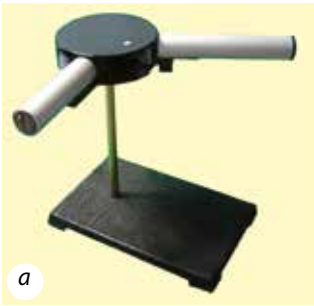
29.3. ábra. Diszperziós spektrum készülék: a - kinézet; b - szerkezet és működési elv
