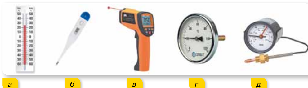
Мал. 122. Термометри різних конструкцій: а — рідинний; б — електричний, в — безконтактний (пірометр); г — біметалевий; д — газовий
