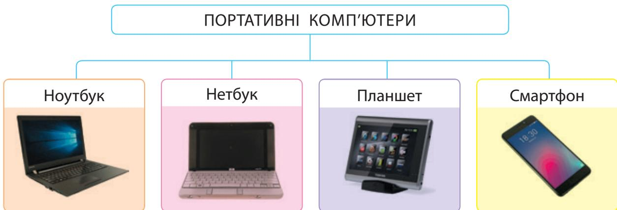
**Ноутбук** — потужний переносний комп'ютер, який зручно використовувати в будь-якому місці. Він виконує всі функції звичайного стаціонарного комп'ютера.
