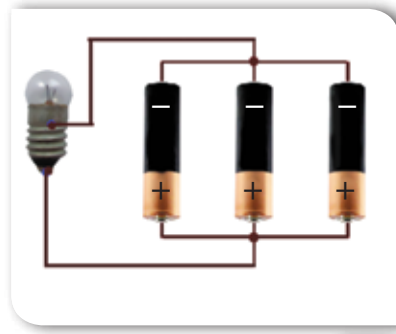
Мал. 134. З'єднання джерел струму: а — послідовне; б — паралельне
