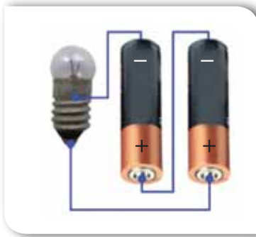
Мал. 134. З'єднання джерел струму: а — послідовне; б — паралельне
