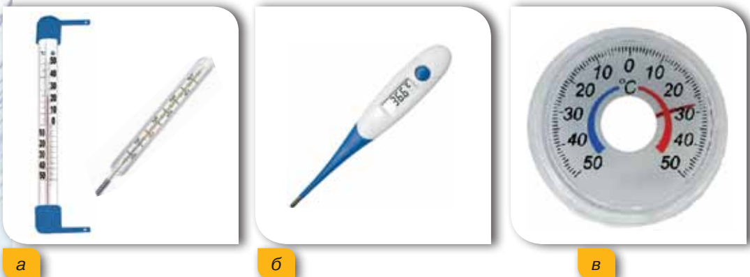
Мал. 17. Термометри різних конструкцій: а — рідинні; б — електричний; в — біметалевий
