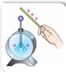
Мал. 99. Електроскоп: а — зовнішній вигляд; б, в — механізм електризації; г — принцип дії
