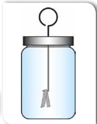
Мал. 102. Саморобний електроскоп
