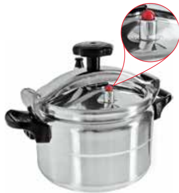
14.5. ábra. Gyorsfőző fazék (kukta): a szelepnek és a hermetikus fedőnek köszönhetően az edény belsejében megmarad a nyomás, ezért a víz forráspontja az ilyen edényben megközelítőleg 120 °C.
