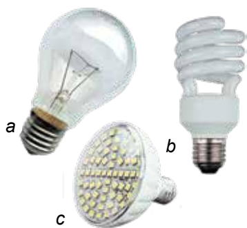
24.3. ábra. Elektromos égők – az elektromos áramot részben fényre alakító berendezések: a – izzólámpa (hatásfoka – 5%); b – energiatakarékos fénycső (hatásfoka – 10–20%); c – fénydiódás (LED) lámpa (hatásfoka – 50%)
