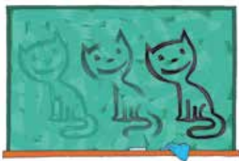
13.5. ábra. A párolgásnak a folyadék fajtájától való függését bizonyító kísérlet. Az alkohollal rajzolt ábra egy perc alatt teljesen eltűnik; a vízzel rajzolt részben megmarad; az olaj párolgása észre sem vehető
