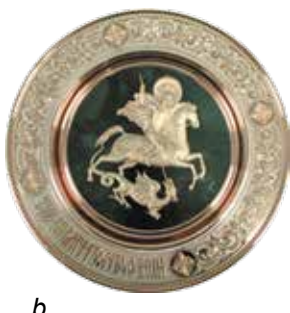
38.4. ábra. Domború másolatok készítése elektrolízis segítségével: a – a berendezés vázlatrajza: a grafittal bevont viaszinta a katód (1), az ezüstlemez az anód (2); a kádban ezüst(I)-nitrát oldat van; b – a kapott másolat
