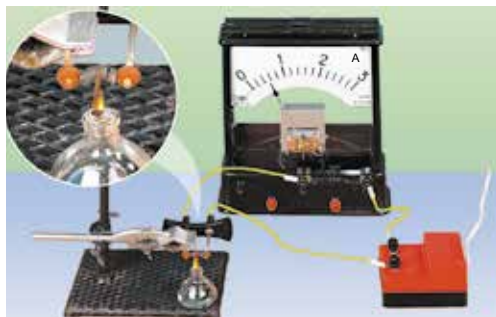
36.3. ábra. A fémek ellenállásának hőmérséklettől való függőségét bemutató kísérlet. A melegítés folyamán az áramerősség csökken, tehát a spirál ellenállása nő
