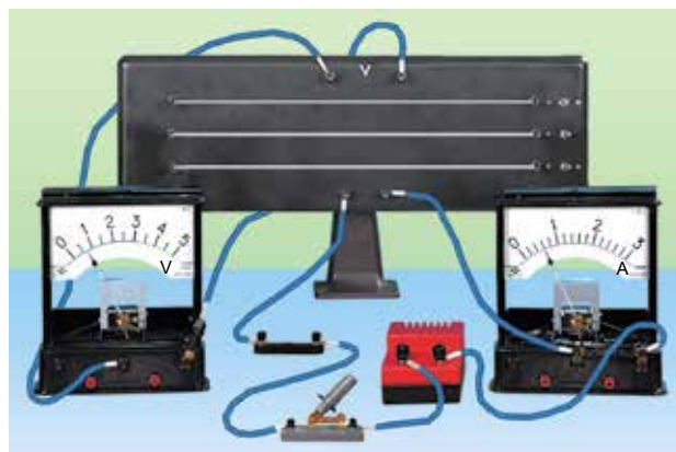
30.2. ábra. A vezető ellenállása és keresztmetszete közötti fordított arányosságot igazoló kísérlet
