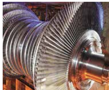
17.3. ábra. A modern turbinákban a gőz energiájának maximális kihasználása érdekében több, ugyanarra a tengelyre rögzített, lapátokkal ellátott keréket használnak
