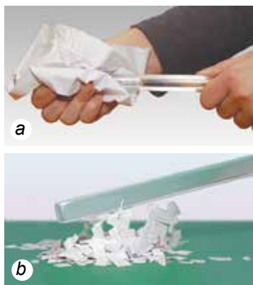
19.1. ábra. Plexirúd feltöltéséhez elegendő papírral megdörzsölni azt (a). Nem sokáig tartó dörzsölés után a rúd apró testeket kezd vonzani magához (b)
