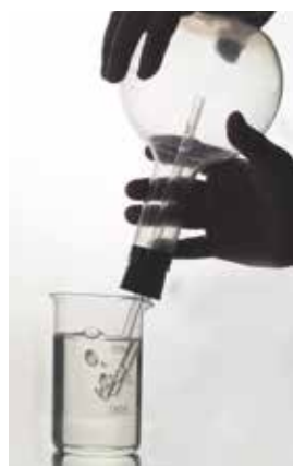
2.1. ábra. Melegítés hatására a lombikban lévő levegő kitágul és egy része az üvegcsővön át buborékokat alkotva távozik
