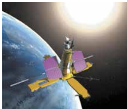
25.3. ábra. A Föld körül keringő műhold napelemi az összes berendezést ellátják elektromos energiával. A napelemek a fényenergiát alakítják át elektromos energiává
