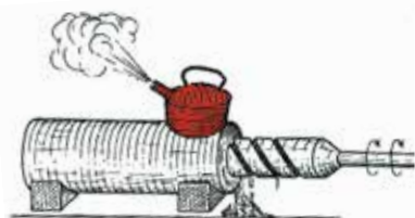
4.3. ábra. Rumford kísérletének vázlatja: a vashenger tetejére helyezett üstben felforr a víz, mialatt lyukat fúrnak a hengerbe
