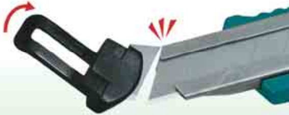
Мал. 74. Відламування частини леза ножа, яка затупилася під час роботи
