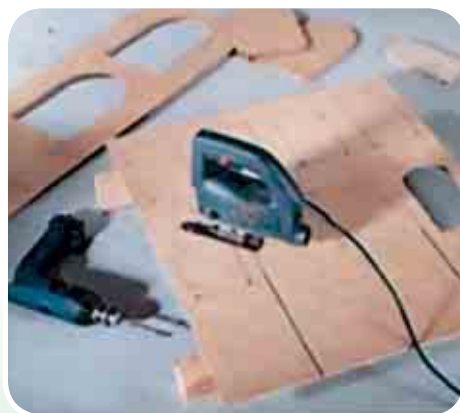
Мал. 199. Випилювання деталей електролобзиком
