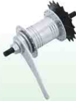
Мал. 119. Велосипедна втулка — приклад періодичного з'єднання обертових деталей
