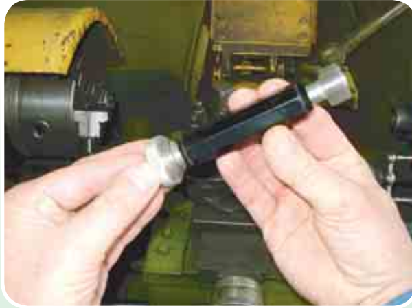
Мал. 132. Приклад використання різьбової пробки типу «прохід—непрохід»
