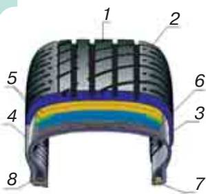
Мал. 4. Будова безкамерної шини: 1 — протектор із гуми; 2 — плече покришки; 3 — капроновий корд; 4 — захисна бічна смуга з жорсткої гуми; 5 — брекер зі сталевго корду; 6 — протекторне кільце з гуми; 7 — силоне кільце з металкорду; 8 — борт для встановлення
