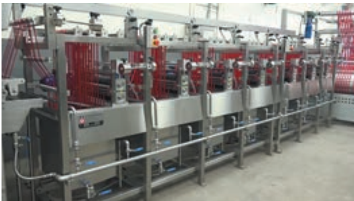
Машини для фарбування тканин Elast Nylon + Polyester (FH1-2015)
