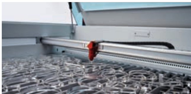
Рис. 5.5. Різання оргскла на верстатах із ЧПК
