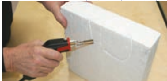
Рис. 5.13. Різання пінопласту імпульсним паяльником
