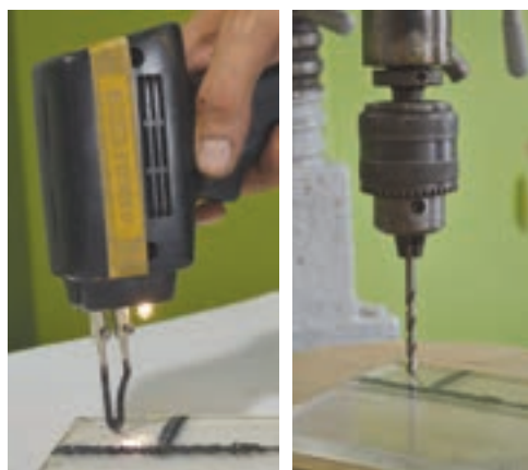
Рис. 4.4. Розмічання оргскла за допомогою імпульсного паяльника для наступного свердління
