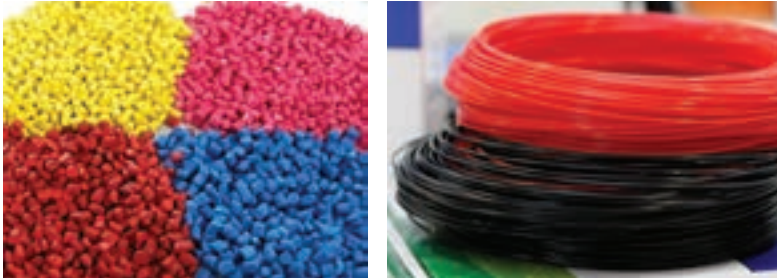
Рис. 4.8. Пластик у формі гранул і дроту — сировина для 3D-друку
