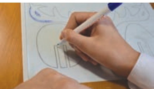
Рис. 4.2. Розмічання заготовки з оргскла
