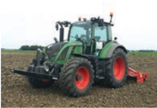
Рис. 8.11. Трактор Fendt, оснащений системою Probotiq, перетворюється на безпілотник
