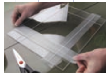
Рис. 6.3. Склеювання деталей з оргскла за допомогою двосторонньої адгезивної або самоклеєної стрічки
