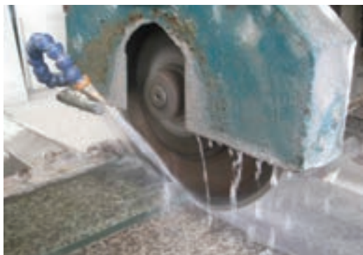
Рис. 5.2. Різання скла дисковими пилками
