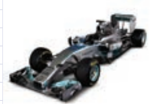
Рис. 1.8. Болід Mercedes AMG F1 W05 з вуглецевого пластику й пористих композитів
