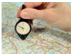
Măsurarea liniilor curbe pe hărți cu ajutorul curbimetrului
