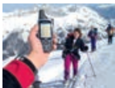
Navigatorul GPS oferă posibilitatea să aflăm părțile orizontului, azimutul, distanța până la obiectul necesar, să stabilim viteza de mișcare
