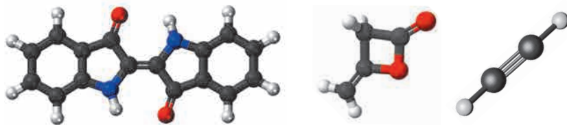
Рис. 49. Способи розташування зв'язків у ланцюжках Карбону
