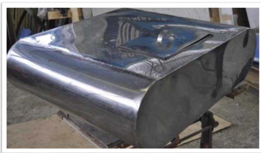
Рис. 16. Бак з оцинкованої сталі.
