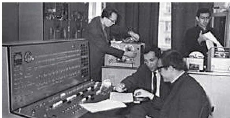
Fig. 1.7. Panoul de comandă al MEC „Minsk” cu diferite sisteme de introducere și afișare a datelor
